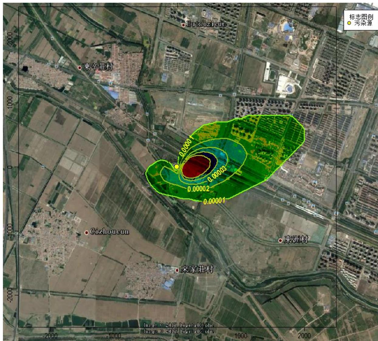
图 6-1-15 PM<sub>10</sub> 年均值区域等值线图 (单位 mg/m<sup>3</sup>)
